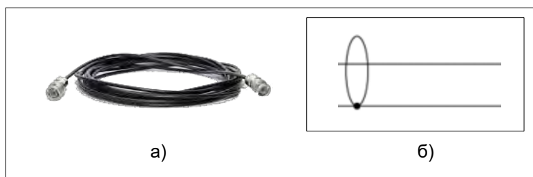
Рис. 16 – Сигнальный кабель: а – внешний вид, б – изображение на схемах
